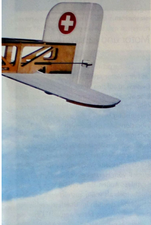
Der fachwerkartige Heckausleger aus Balsa ist dagegen eher filigran gebaut.
