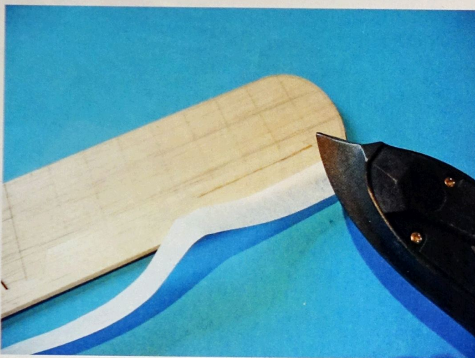
Die Motor-Attrappe besteht auch aus gelasertem Holz und wird auf den Motor geklebt. Zuvor sollte man sie wuchten.
